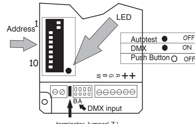
1) Conectar el sistema a la central DMX respetando la posición de los cables (A) y (B) según las indicaciones - Seguir las instrucciones de instalación del sistema RS485-DMX
