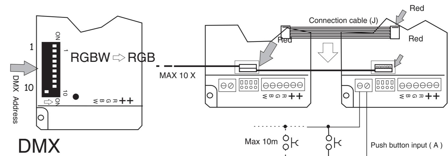
1) Collegare il sistema alla centralina DMX rispettando il cavo A e B e la polarità come indicato. Seguire le note di installazione secondo il sistema RS485-DMX
