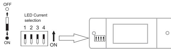
Regolazione della corrente di uscita, verificare prima del collegamento dei led
