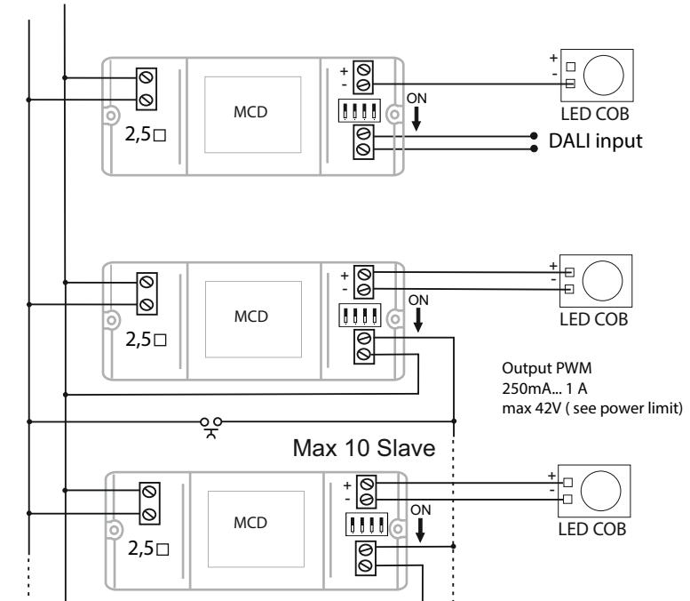
Regolazione della corrente di uscita, verificare prima del collegamento dei Led
