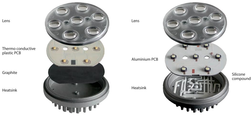
Le due figure qui sopra rappresentano le due diverse tecnologie impiegate per la realizzazione dei moduli Led. La realizzazione standard utilizza un circuito stampato in alluminio per il montaggio dei Led e la pasta siliconica per realizzare il trasferimento di calore verso l'alluminio. La tecnologia sviluppata da QLT prevede il montaggio dei Led su una base plastica termoconduttriva con temperature di rifusione più basse e minore stress sui Led durante il montaggio.
