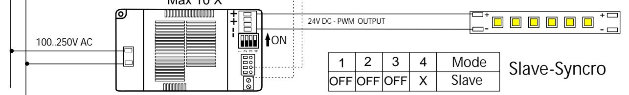
Linea Sincro: usare cavo per BUS dati , tenere lontano da cavi alta tensione per possibili disturbi
