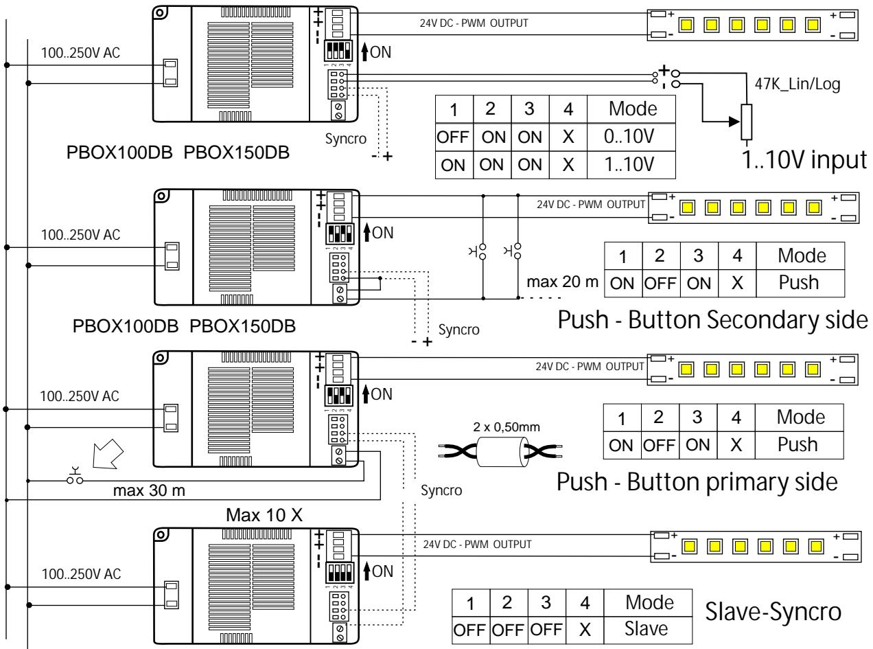
Linea Sincro: usare cavo per BUS dati , tenere lontano da cavi alta tensione per possibili disturbi
